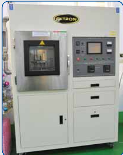
Test resistenza ozono Ozone Resistance Tester
